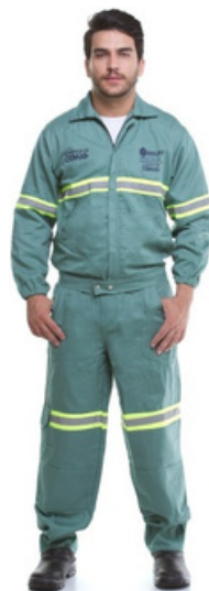
JÚPITER FR Peso: 260g/m 2 Composição: 88% CO / 12% PA CERTIFICADO DE APROVAÇÃO: CAMISA: CA - 37950 ATPV: 11 cal/cm 2
